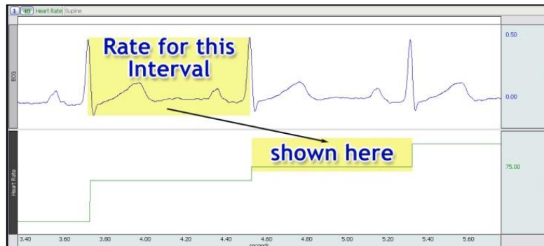
Slika 2.13 Izbor tačkastih podataka iz podataka srčane frekvencije koji koreliraju sa EKG podacima
